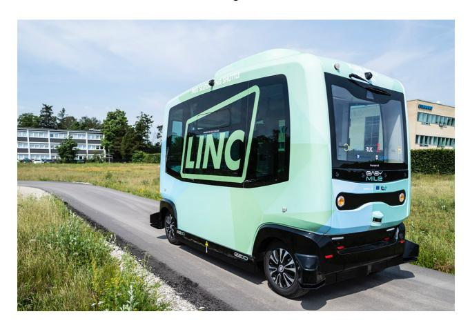
Con una connessione a satelliti e sensori che rilevano eventuali altri utenti della strada o ostacoli lungo il percorso, la navetta ottiene una panoramica del percorso e trova la strada in sicurezza sul DTU Lyngby Campus.
